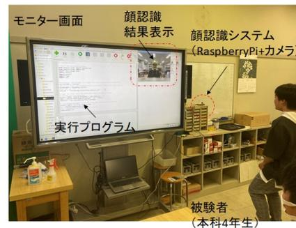
図 10 顔認識プログラムを使った実験の様子
