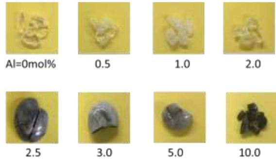
図 2. 作製した  $\text{SiO}_2$  系ガラスの外観図
