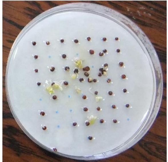
Fig.1 発芽生長試験 3 日後の状況 ((a)試験用水 50 ppm— $ZrCl_4$ 、(b)試験用水 400 ppm— $ZrCl_4$ )。
