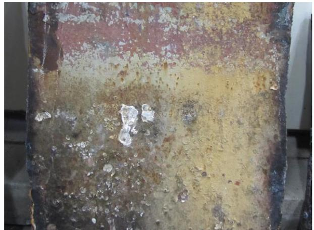
図3 喫水部の鋼板の外観写真
