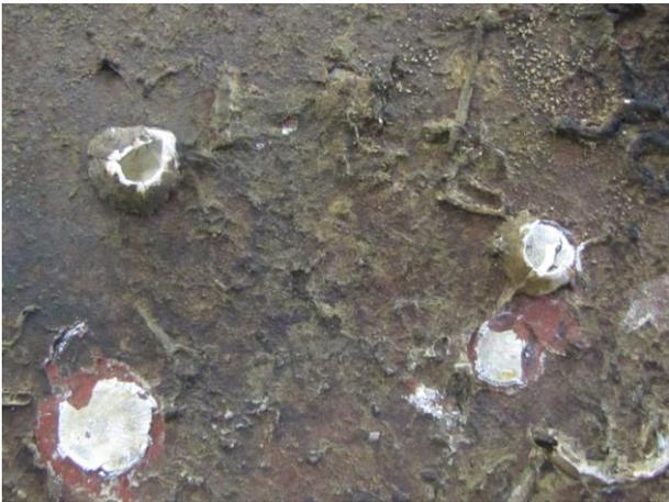
図10 船底部の鋼板の付着生物跡 No.2
