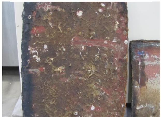
図4 船底部の鋼板の外観写真
