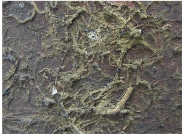
図12 船底部の鋼板の付着生物跡 No.4
