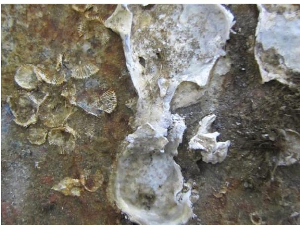
図 6 喫水部の鋼板の付着生物跡 No.2
