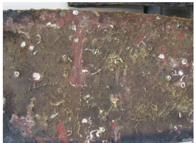
図 8 喫水部の鋼板の付着生物跡 No.4
