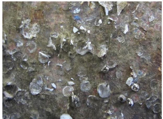
図 7 喫水部の鋼板の付着生物跡 No.3
