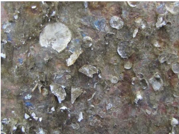
図 5 喫水部の鋼板の付着生物跡 No.1
