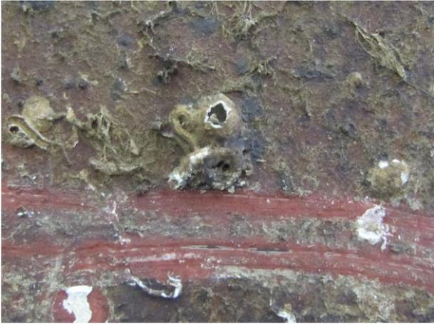
図9 船底部の鋼板の付着生物跡 No.1
