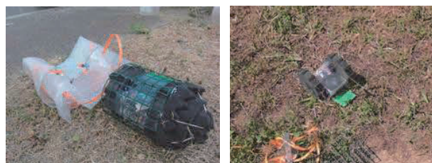
2016年度製作の CanSat (左図に見えるパラシュートを切り離すと、右図のようになって自律走行し、予め決められた目的地に向かう)
