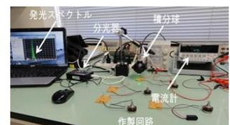
LEDのスペクトルと発光強度測定
