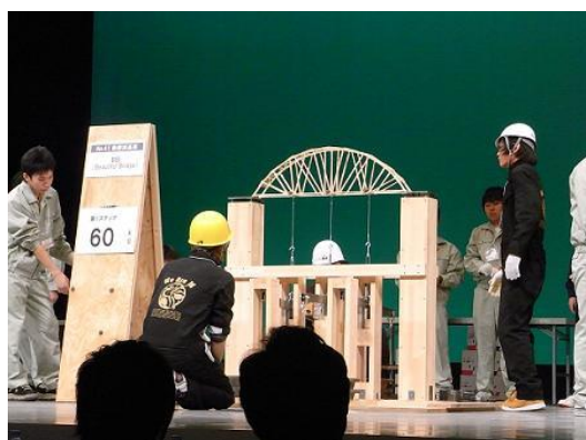
耐荷性能試験中のBB（Beautiful Bridge）
